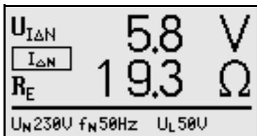
Jestliže je dotykové napětí měřené proudem 1/3 jmenovitého vybavovacího rozdílového proudu a přepočítané na proud  $I_{\Delta N}$  vyšší než t.j.  $U_{I_{\Delta N}} > 25 \text{ V}$  ( $> 25 \text{ V}$ ), pak signálka  $U_L/R_L$  (7) svítí červeně.
