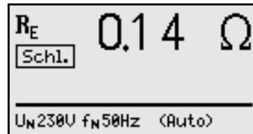
Vezmeme-li za základ stejné průřezy vodičů L a N, tak můžeme orientačně odpor fázového vodiče uvažovat v poloviční hodnotě vnitřní impedance sítě  $Z_1$  (měřeno mezi fázovým a středním vodičem).
