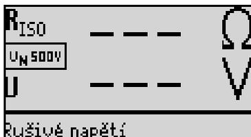
Jednotlivé vodiče (L1, L2, L3 a N) se musí měřit proti vodiči PE!
