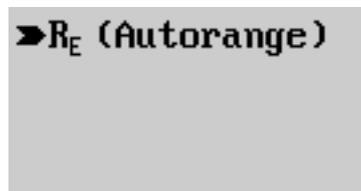
**4** Měření zahájíme stiskem tlačítka Start (3 nebo 17), přičemž se následně na displeji zobrazí výsledky měření. Pro kontrolu funkce vybavení proudového chrániče držte stisknuté tlačítko  $I_{\Delta N}$  (2 nebo 18) po dobu zapnutí přístroje, resp. dokud proudový chránič nevybaví.
