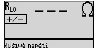
K nalezení chyby měřte odpor v obou polaritách měření.
