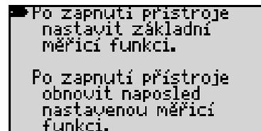
Stiskněte tlačítko Menu (4) a nastavte kurzor podle vašich požadavků. V horní pozici se přístroj po uvedení do provozu nastaví vždy na základní funkci, ve spodní pozici se po zapnutí přístroje nastaví vždy posledně používaná funkce.
