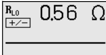
Pokud je rozdíl naměřených hodnot vyšší než je nastaven vyhodnocovací systém přístroje, zobrazí se obě naměřené hodnoty. Rozdílné výsledky měření zobrazené na LCD displeji (1) mohou signalizovat např. napětí na měřeném objektu vzniklé např. termoelektrickým napětím nebo cizím napětím.
