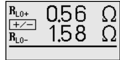
K těmto výsledkům lze dospět zejména v zařízeních s ochranou odpojením bez samostatného ochranného vodiče (dříve nulování). Důvodem mohou být v tomto případě paralelně připojené impedance nebo vyrovnávací proudy. Dále mohou mít vliv odpory, jejichž hodnota se v průběhu měření může měnit (např. indukčnosti) nebo také nedokonalý kontakt při měření (dvojitá zobrazení hodnot na displeji).
