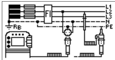
Proudový chránič může být používán pouze v sítích TN-S. V sítích TN-C nebude proudový chránič fungovat, když není vodič PE veden mimo proudový chránič, nýbrž je na zásuvku veden společně s vodičem N. Tak bude chybový proud téci proudovým chráničem zpět a nevznikne tak žádný rozdílový proud, který by způsobil vybavení proudového chrániče.
