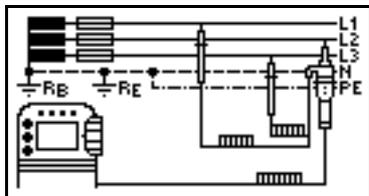
K měření použijte výměnný adaptér dvojpólový (12) do kterého připojíte další šňůru s měřícím hrotem a tím rozšíříte adaptér na trojpólový.
