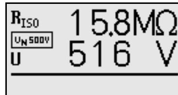
Když je izolační odporu nižší než nastavená limitní hodnota (viz část 11.3) tak se rozsvítí signálka  $U_L/R_L(7)$
