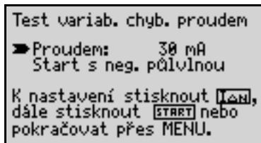
Každým stiskem tlačítka  $I_{\Delta N}$  / i se hodnota proudu zvýší o 1 mA. Při trvalém stisku tohoto tlačítka se proud zvyšuje automaticky plynule. Po několika vteřinách se rychlost změny zvyšuje. Když potřebujete nastavenou hodnotu např. snížit, držte stisknuté tlačítko  $I_{\Delta N}$  / i a stiskněte současně opakovaně nebo trvale tlačítko Menu. Když dosáhnete požadované hodnoty zkušebního proudu, tak se může stiskem tlačítka Start provést zkouška jak je popsáno v části 7.1.
