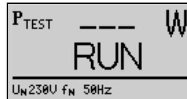
Po ukončení zkoušky se zobrazí údaj o zkušebním výkonu. Přístroj je následně připraven pro další zkoušení („READY“).
