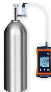
kalibrace zkušebním plynem
