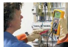
Test izolace na deskovém rozvaděči
