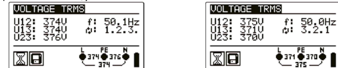
Obr. 5.17: Příklady měření napětí v třífázovém systému
