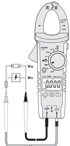
**Voor het meten van gelijkspanningen "DC" (V $\overline{\text{---}}$ ) gaat u als volgt te werk:**
